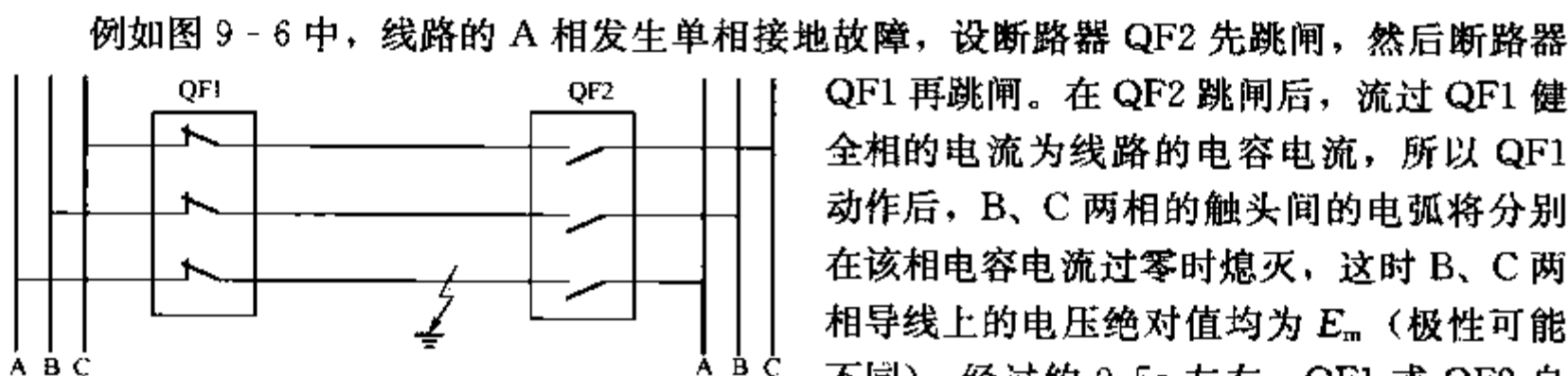
图 9-6 中性点有效接地系统中的单相接地故障和自动重合闸示意图
