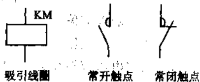
图 1-13 接触器的图形和文字符号
