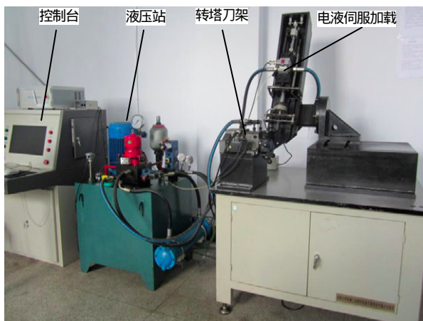
图 4 转塔刀架可靠性试验系统
