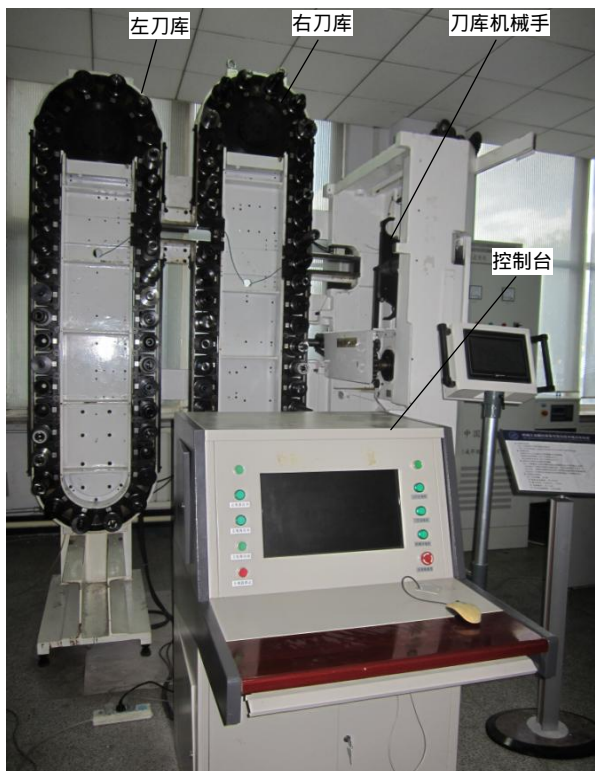
图 6 链式刀库可靠性试验系统
