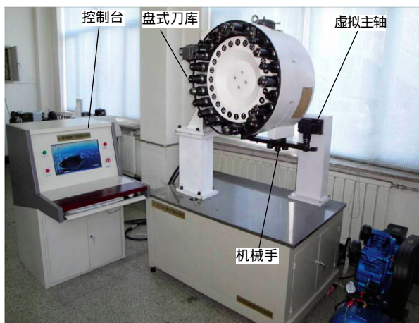
图 5 盘式刀库可靠性试验系统
